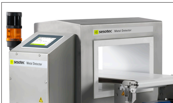
Detector de metales GLS con diseño higiénico integrado en el sistema VARICON+D.
