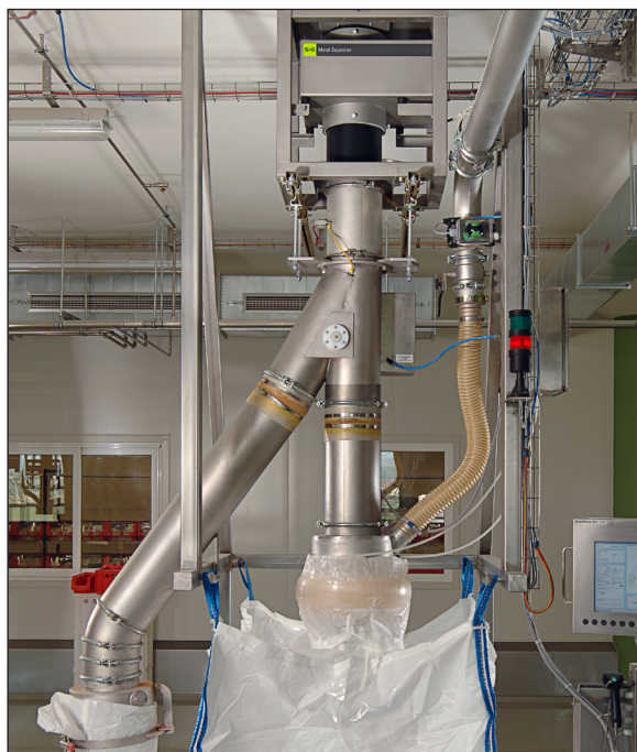
Ejemplo de instalación: Detección de metales conforme con IFS antes del llenado de especias en Bigbags. (versión antigua)
